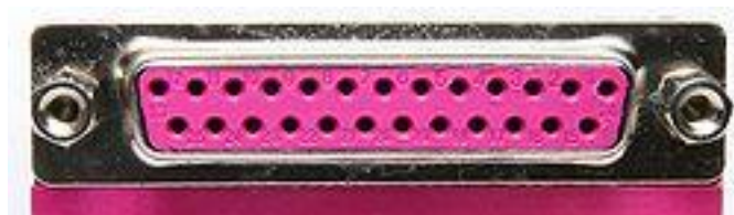
Рисунок 1 – 25-контактный разъем DB-25, используемый как LPT-порт на персональных компьютерах (IEEE 1284-A).
