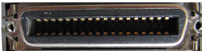
Рисунок 2 – Кабельный 36-контактный разъем Centronics для подключения внешнего устройства (IEEE 1284-B).
