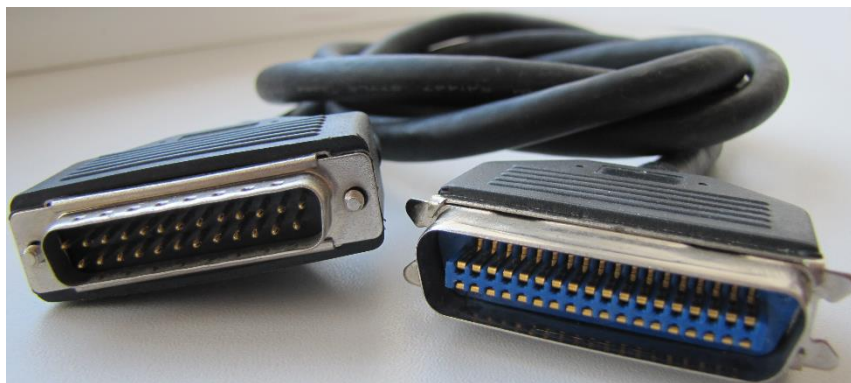
Рисунок 3 – АВ-Кабель для подключения периферийных устройств к компьютеру по параллельному порту (25-контактный разъем DB-25-male на одной стороне и 36-контактным IEEE 1284-B на другой).
